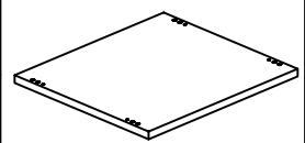
Положить полку нижнюю (I) на чистую ровную поверхность глухими отверстиями вниз. В сквозные отверстия Ø8мм вбить крепежи опор (4). В крепежи опор (4) вкрутить регулируемые опоры (5) (рис. 1). Поставить полку нижнюю (I) на опоры.
